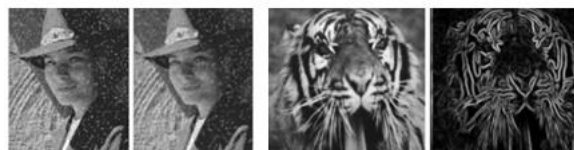
Gambar 1. citra dengan tingkat noise yang berbeda (panel kiri) dan struktur yang diekstraksi (tepi) dari citra asli (panel kanan)
