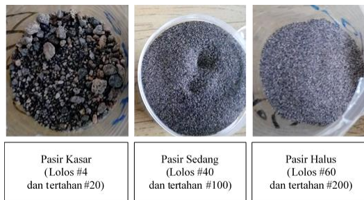
Gambar 4.3 Pasir Seragam tiga jenis untuk campuran pengujian kompaksi
